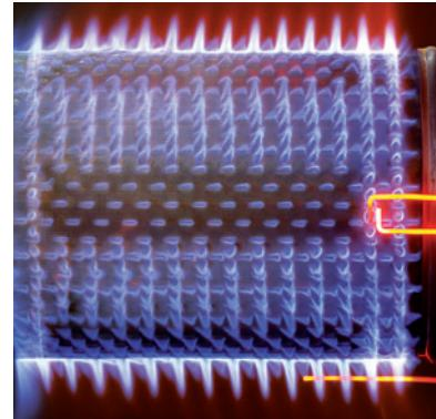
Модулируемая цилиндровая горелка MatriX с системой управления горением Lambda Pro Control
