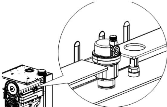
Водогрейные конденсационные котлы **WALLCON X-treme 115-150 кВт** оборудованы автоматическими воздухоотводчиками.
