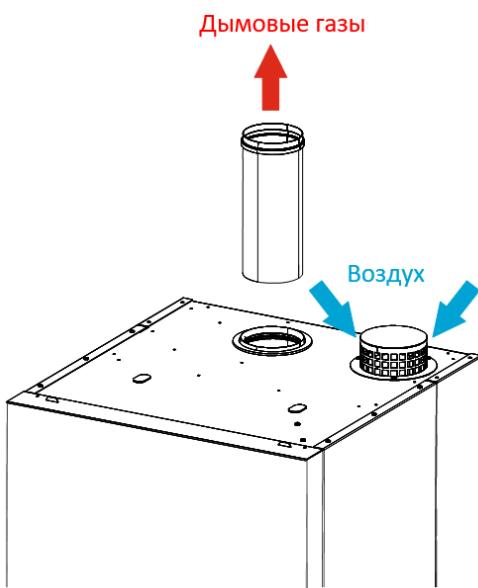
Если необходимо использовать соединение дымохода типа B23, следует использовать переходник для всасывания чистого воздуха, а отработанный газ следует отводить во внешнюю среду через трубу Ø100 мм.
