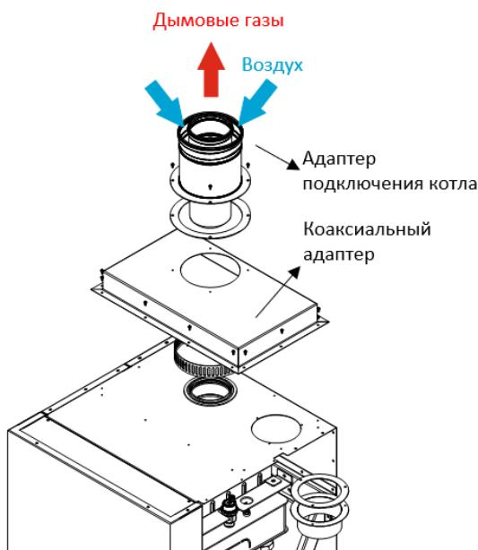
Если в котлах модели WALLCON X-treme применяется соединение дымохода типа С13, С33 (коаксиальный); Используйте комплект коаксиального дымохода и коаксиальный адаптер
