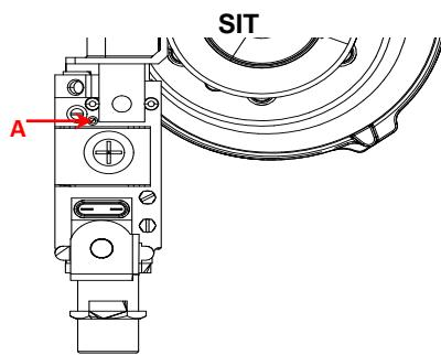
Поворачивайте винт регулировки объема подаваемого газа в номинальном режиме (A) по часовой стрелке для увеличения значения CO<sub>2</sub>. Если поворачивать этот винт против часовой стрелки, то расход газа будет уменьшаться и, таким образом, будет уменьшаться и значение уровня CO<sub>2</sub>.
