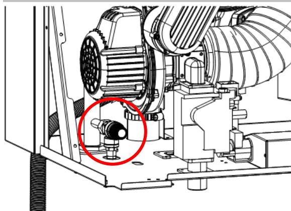
**WALLCON X-treme** оборудован встроенным предохранительным клапаном. Дренажный шланг от предохранительного клапана должен быть подключен к системе канализации.
