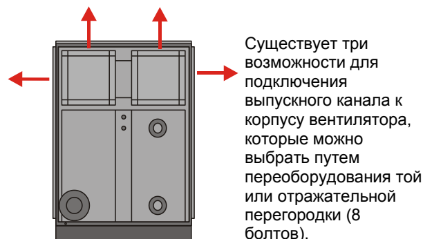
Рис. 10 Подключение. Возможность для Выхлопной канал
