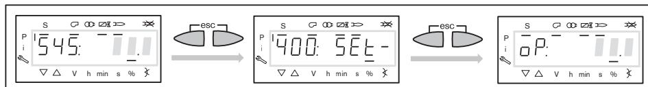
**24. Корректировка положения воздушных заслонок на продувке**
